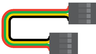
Четырёхпроводной шлейф Соединяет дальномер и плату
